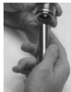
3. Photo montrant le piston rodé et partie supérieure.
